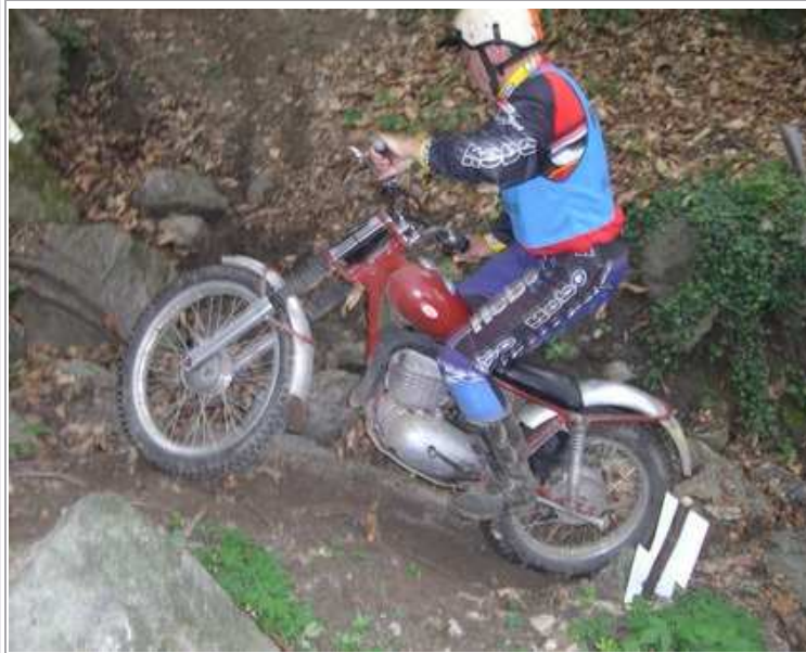
Günther Ruttloff auf Jawa 250 Interessant: Kicker und Schaltung sind auf derselben Welle !!!
